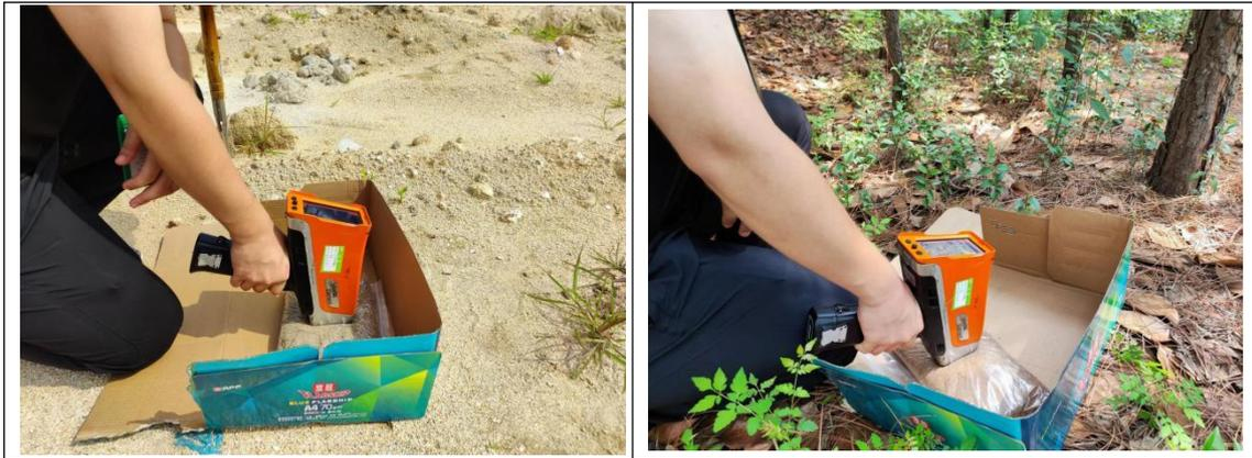
图6-2 现场土壤快速检测照片
